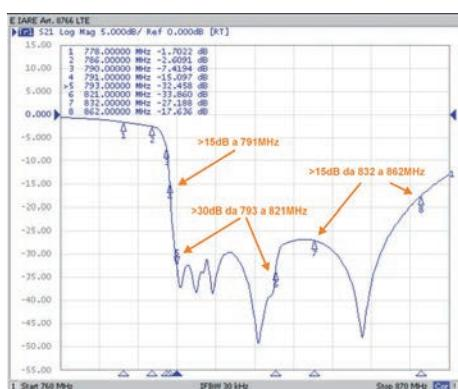
Diagramma di taratura Art. 8766 LTE
