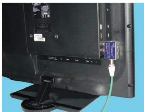
**Esempio di installazione del filtro 7601 LTE direttamente sulla boccola di ingresso del decoder DTT o del televisore**
